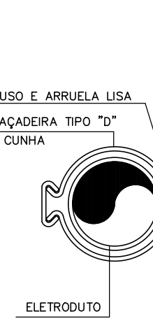
DETALHE DE INSTALAÇÃO DO ELETRODUTO APARENTE NA PAREDE
